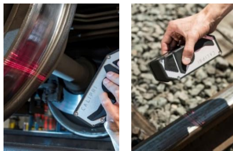
KERÉK- ÉS/VAGY SÍNPROFIL MÉRÉSE
