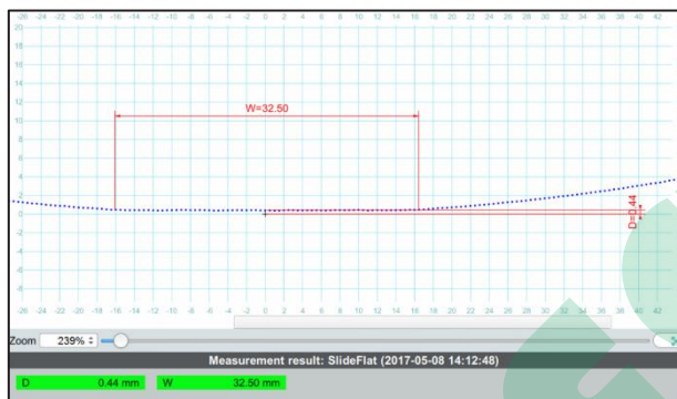
KOPÁS (SLIDFLAT) MÉRÉSI MÓD
