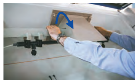
2. A kombinált légfűvő és oszcilláló rúd egység könnyen kiemelhető.
